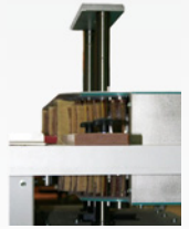
Agregat Duplex z 30-milimetrowym ruchem oscylacyjnym i pneumatyczną regulacją wysokości obszarów roboczych
