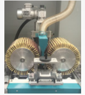
Podwójne szczotki szlifujące obracają się synchronicznie oraz w przeciwnym kierunku.
