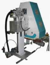
Agregat RB300 z elektryczną regulacją wysokości i jednostką oscylacyjną
