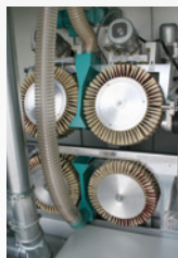
Sterowana programem oś odchylna pozycjonuje górny agregat szlifujący.
