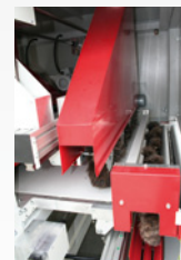
Poprzeczny agregat oczyszczający, opcjonalnie również od dołu, wyposażenie do wyboru w szczotki obrotowe lub taśmę szczotkową
